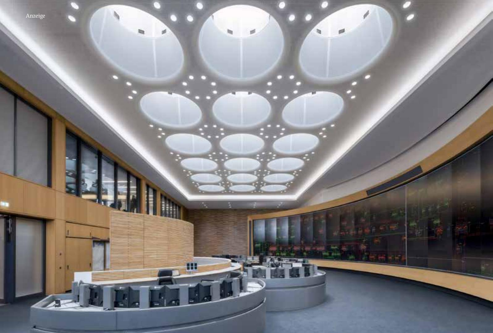
Das natürliche und gesunde Licht der Sonne wird über Tubes mit elektrochromer Dachverglasung in den Raum der Schaltwarte eingestrahlt. Die künstliche Beleuchtung wird gemäß Biorhythmus in verschiedenen Farbtemperaturen zugeregelt
